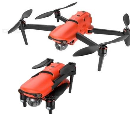
Дроны оснащены запатентованной системой обхода препятствий – Autel Dynamic Track 2.0, что позволяет обнаружить потенциальную опасность на расстоянии до 30м и заранее спланировать оптимальную траекторию облета. Для эффективного отслеживания преград на борту присутствуют 12 оптических датчиков и 2 ультразвуковых сенсора, управляемых двухъядерным процессором. Система способна отслеживать до 64 объектов одновременно, в том числе людей, транспорт или животных.
